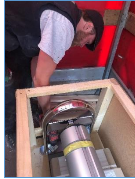
Stirnseite öffnen und Rollabdeckung vom Kistenboden lösen.
